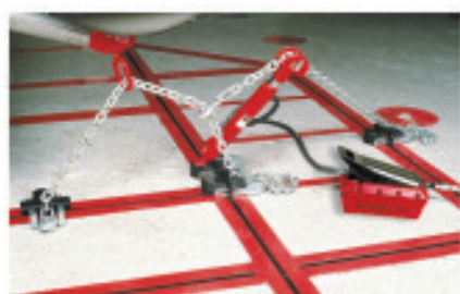
Downward pull. Traction de haut en bas. Zug von oben nach unten. Neewaarts trekken.
